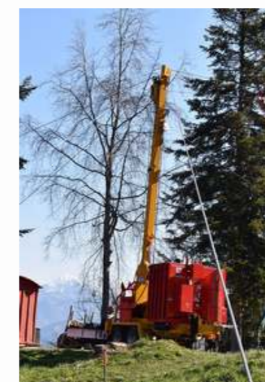
^ Quatre haubans permettent de stabiliser la machine. Il faut ensuite deux jours à trois personnes pour disposer les câbles et faire le montage.
